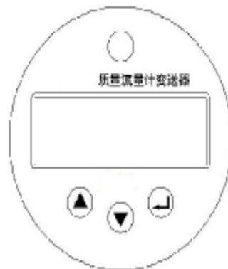
图十二 复合型流量计变送器前面板示意图
